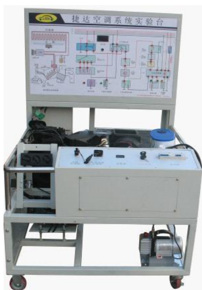
图 21 捷达汽车空调实训台实训台架
